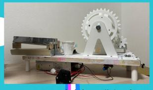
ペットボトルを手作りの機械で溶かし 3D プリンターの素材フィラメント を作ります。
